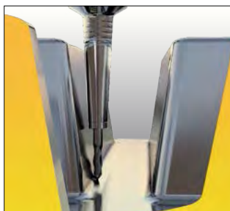
干渉のあるボールエンドミル仕上げ加工 Finishing with ball endmill in tight space
