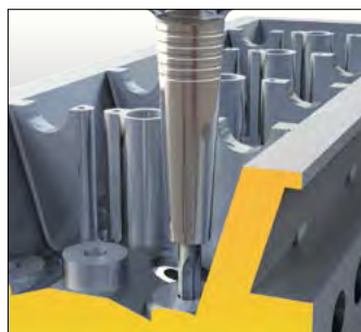
干渉のあるリーマ加工 Reaming in tight space
