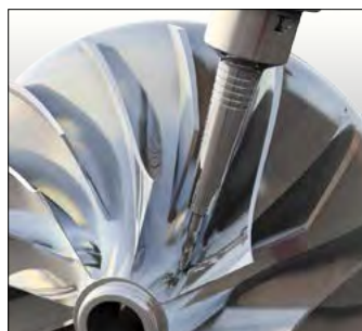
5軸のボールエンドミル仕上げ加工 Finishing with ball endmill on 5-axis machine
