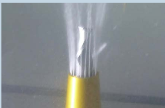
Aufsteckhülse mit Düsen – ineffektive Kühlung, Kühlmittel gelangt nicht zur Schneide Насадки с соплами – неэффективное охлаждение, СОЖ не достигает режущей кромки
