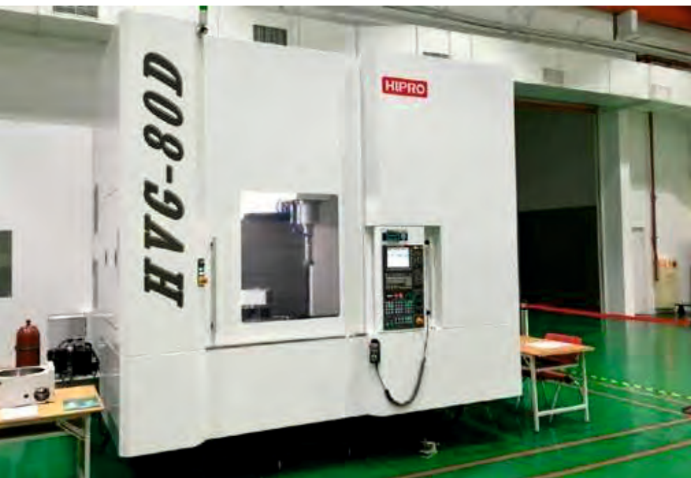
Вертикальный шлифовальный станок с функцией термического контроля
