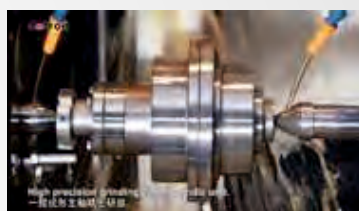
Шлифовка шпиндельного узла
